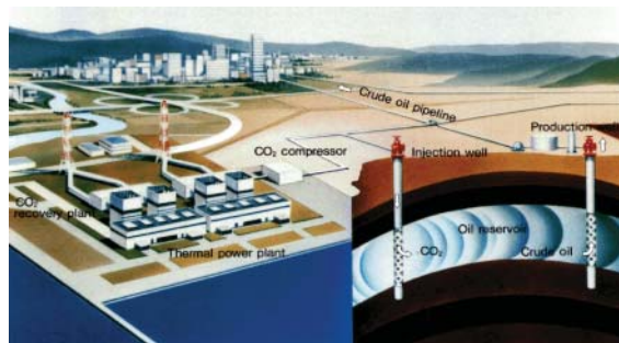
写真-1 発電所排ガスからCO 2 を回収しEORを行う概念図
