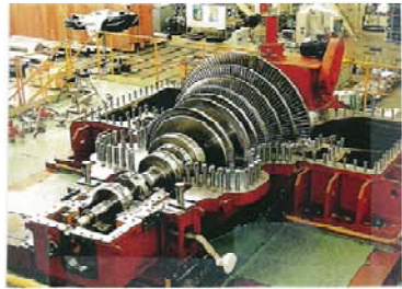
・蒸気タービン
